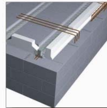
Plancher Hourdis Béton Rupteur Total : Stoptherm EB
