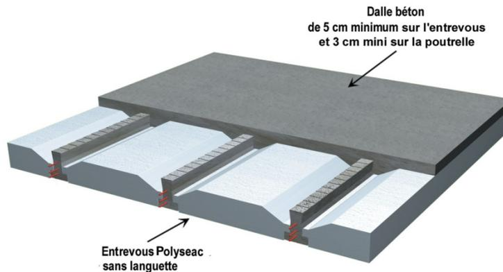
Les planchers isolants seront constitués par un montage type SEAC ou similaire composé de poutrelles précontraintes en béton précontraint et d'entrevous isolants type polyseac ou similaire de classe au feu M1. La sous-face du plancher devra présenter un aspect continu sans décaissé, ni poutrelle visible.
