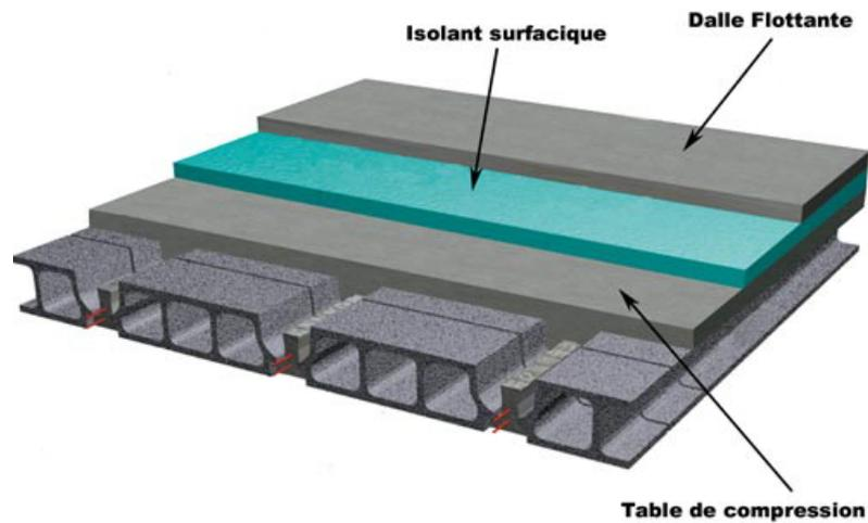
Le plancher sera constitué d'un montage type SEAC constitué de poutrelles en béton précontraint et d'entrevous béton dit "de coffrage résistant".
