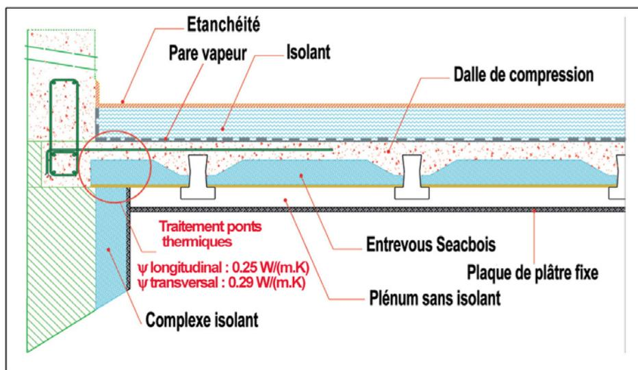
Les planchers seront constitués par un montage type SEAC ou similaire composé de poutrelles en béton précontraint et d'entrevous Seacbois.
